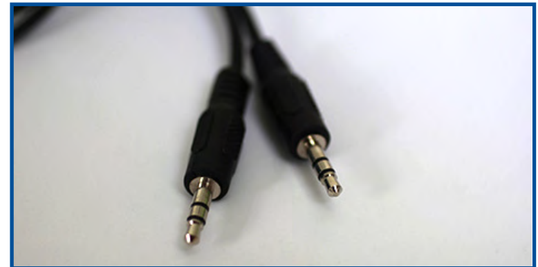
3, 5 mm - eller 1/8"- eller minitele. På bilden är det en balanserad kontakt. Tyvärr allt vanligare på lite billigare utrustning.
