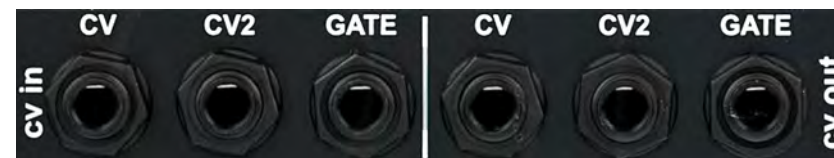
Kontakter för Controlled voltage och Gate. Nörd fakta: Baksidan av Analogue Solutions Telemark.
