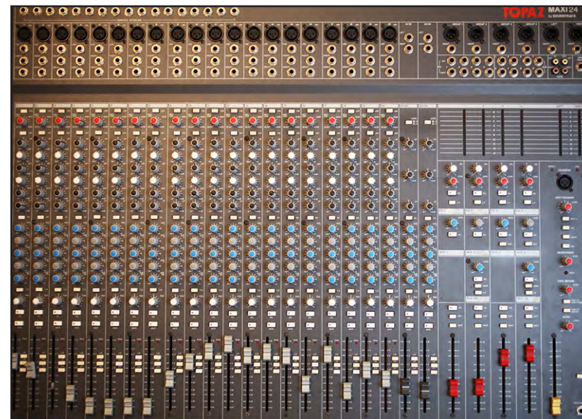
Här ett mixerbord för livebruk. Samliga in- och utgångar sitter lätt åtkomliga på ovansidan. Nördfakta: Soundtracs Topaz Maxi 24.
