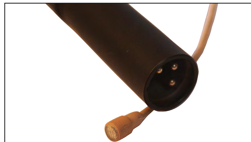
Sennheiser MKE253 är en lavaliermikrofon, Den är hudfärgad för att inte synas i pannan, kinden eller högt upp på bröstet där det är meningen att man ska fästa den, oftast med kirurgtejp. Eftersom den endast är ett par millimeter stor syns den knappt ens från första raden. Eftersom man inte talar eller sjunger direkt in i mikrofonen är karaktäristiken omnidirektionell.
