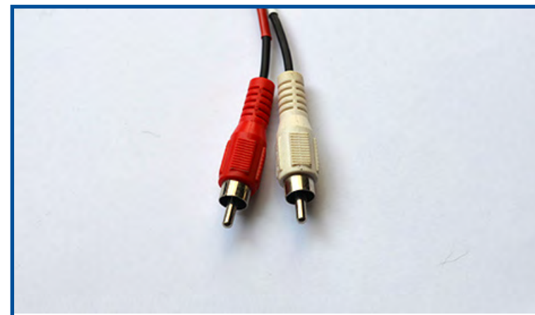
RCA-kontakter. De brukar vara antingen röda och vita, men ibland är de röda och svarta. Det är ingen funktionell skillnad mellan dem. Ta för vana att den röda ALLTID ska kopplas till höger kanal. Det spelar egentligen ingen roll men om du följer rådet kommer du aldrig göra fel.
