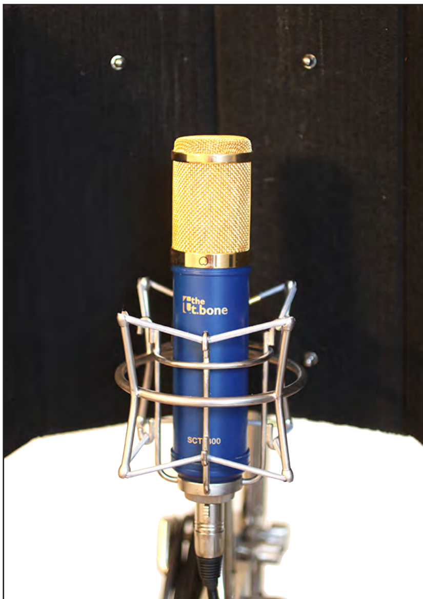
the t.bone är en rörbestyckad kondensator mikrofon. Elektronröret ger en lite varmare känsla i ljudet. Lägg även märket till mikrofonens upphängningsanordning. Mikrofonen hänger i gummiband som tar upp vibrationer.
